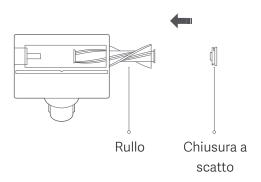
6. Con la chiusura a scatto laterale della testina a spazzola rivolta verso l'utente, utilizzare una moneta per ruotare il meccanismo in senso orario fino alla posizione di blocco, assicurandosi che il rullo sia in posizione.
