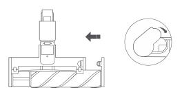
6. Ruotare la chiusura a scatto di 90° in senso orario fino alla posizione di blocco per fissare il rullo.
